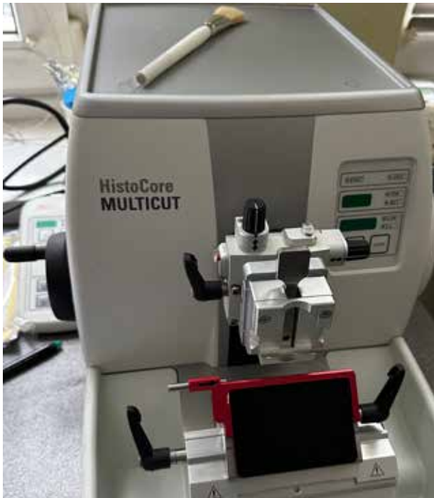
Mikrotom rotacyjny półautomatyczny Leica HistoCore Multicut
