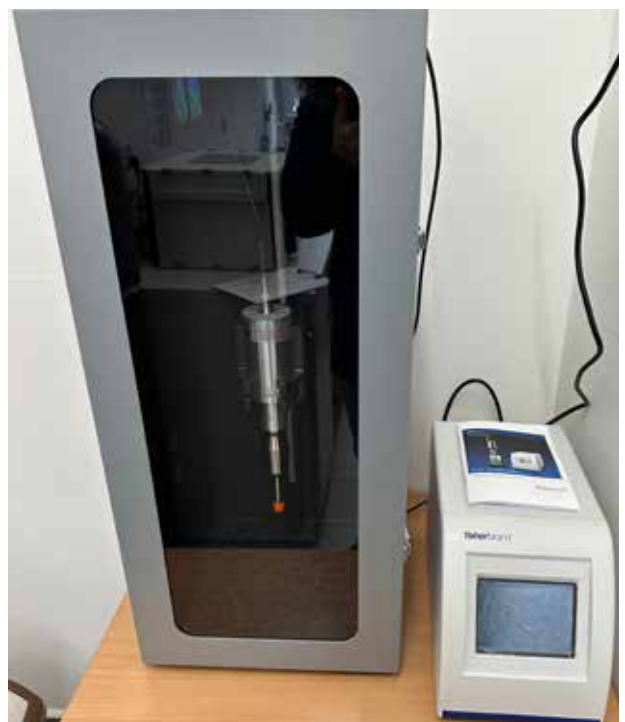
Sonicator Q705 z sondą
